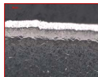
Micrografia 500X - Strato niturato su AISI H13, assenza di nitruri a bordo grano. (Colmegna S.p.A.)
